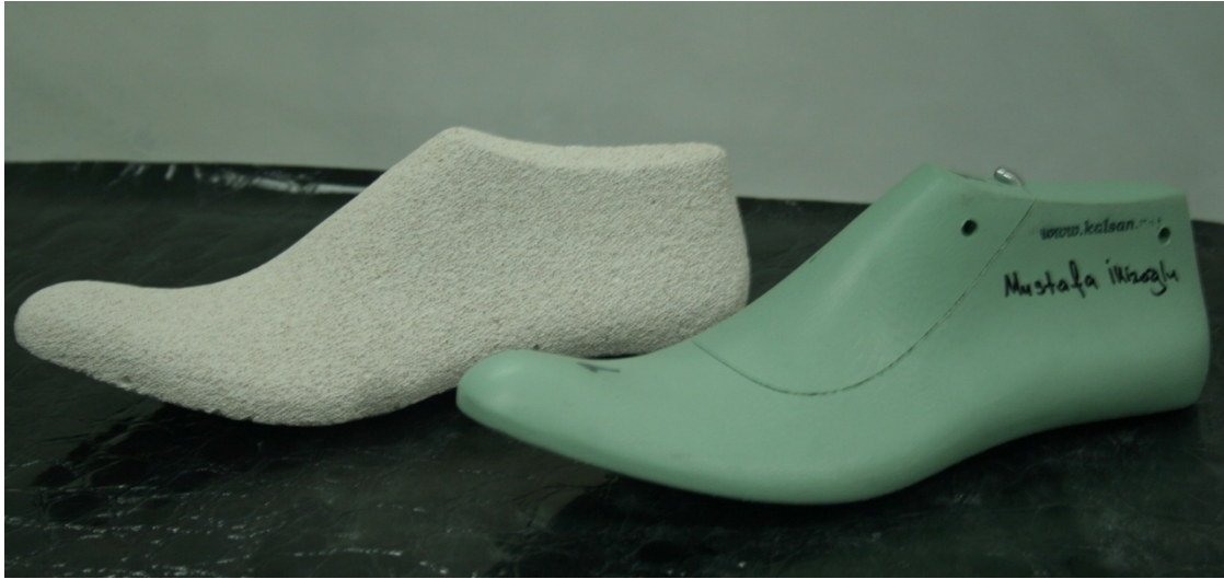
Resim- 8: Kalıp ve gazbetondan hazırlanmış maketi..
